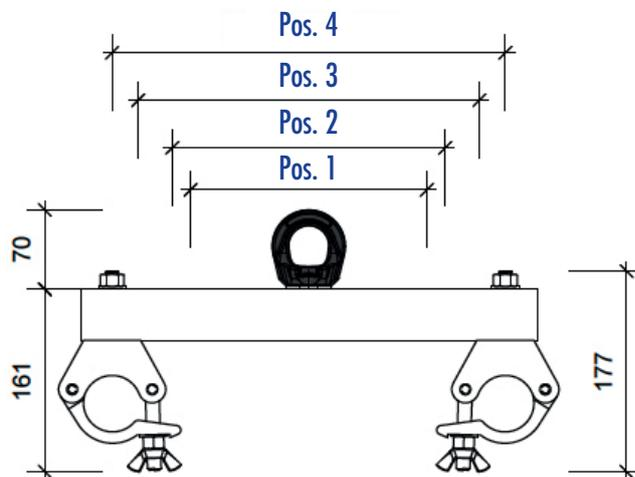
Durch Umsetzen der verschraubten Befestigungsschellen in die vorgesehenen Bohrungen können unterschiedliche Traversensysteme beispielhaft angeschlagen werden.
